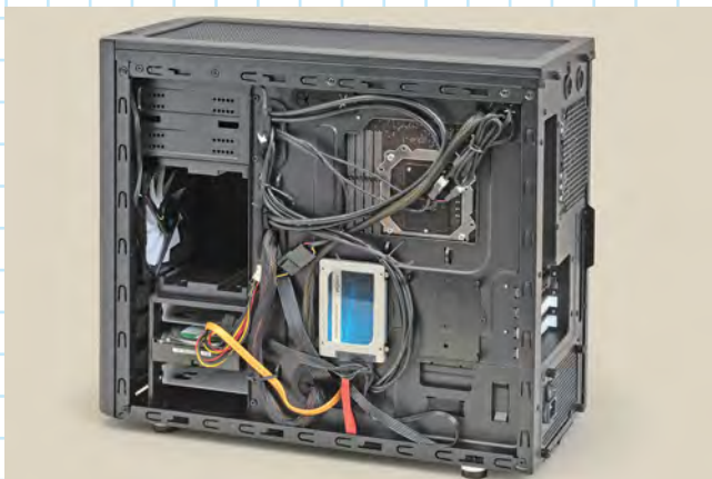
配線された裏面の様子だ。ケーブルは多いが、結束バンドとマザーボードベース裏のフックでキレイに整理できた。SSDもマザーボード裏面のシャドーベイに組み込んでいる
