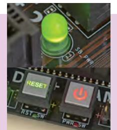
5V給電を示すマザーボード上のスタンバイ電源LED。スイッチボタンがその役割を兼ねているものもある
