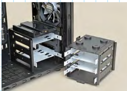
中央3基分のシャドーベイユニットは、上下の手回しインチネジを外すことで手前側に引き抜けるようになっている
