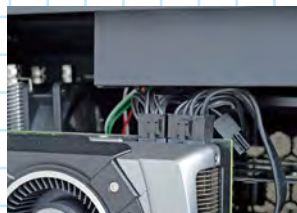
電源コネクタ用のスペースは狭い。上ではなく、横方向に電源コネクタを装備するビデオカードのほうが相性はよいだろう
