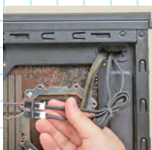
次にマザーボード裏面で、ファンコントロールユニットのファンコネクタに接続する
