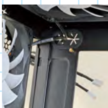
ファンの向きを変えることで、マザーボード上にある穴にケーブルを通しやすくなった
