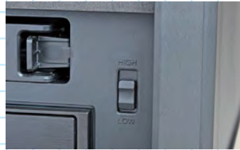
前面カバーの奥に、ファンコントロールユニット用のスイッチを装備する。2段階でケースファンの回転数を制御できる
