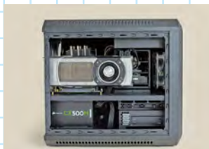
長さが26.7cmもあるエルジャパンの高性能ビデオカード「GeForce GTX 780」を組み込んだ状態。まだ前面方向には余裕がある
