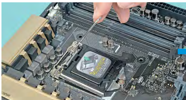
CPUソケットにCPUを装着したら先ほどとは逆の手順でフレームを固定する
