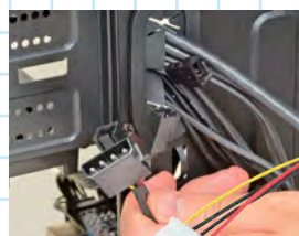
ファンの向きを変えることで、マザーボード上にある穴にケーブルを通しやすくなった
