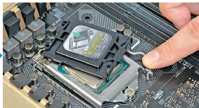
フレームを固定するとCPUソケットの保護カバーが外れる。この保護カバーはマザーボードを修理に出すときに必要なので、保管しておく
